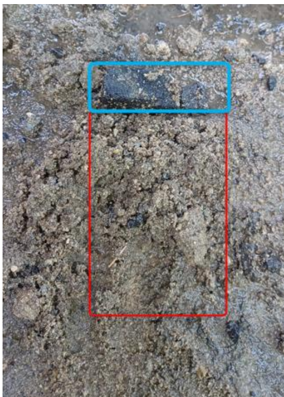
Fot. 1. Pozostałość po warstwach w odwiercie numer 2, grunt stabilizowany uległ całkowitej degradacji
